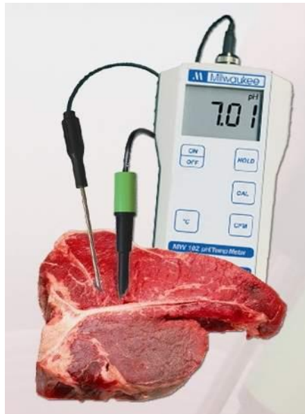
Slika 2.2.1. Mjerenje pH u mesu pomoću prijenosnog pH metra
