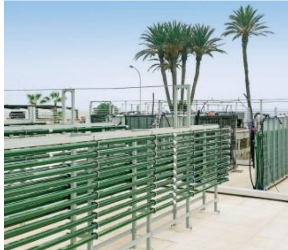
Slika 2.2.2.2. Zatvoreni fotobioreaktori. Izvor: Bosak (2017.)
