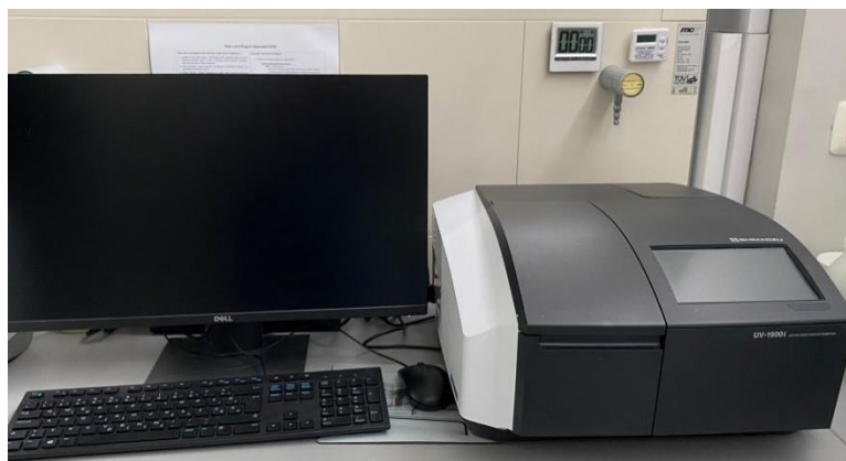
Slika 3.5.3. Spektrofotometar SHIMADZU UV-1900i i računalo za obradu, Zavod za Kemiju. Izvor: Kovar (2022.)
