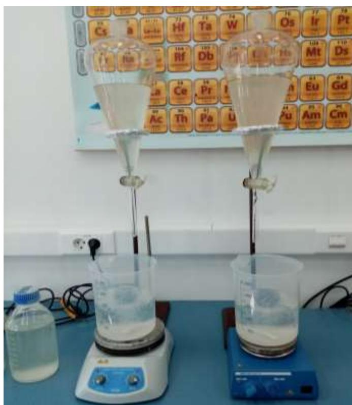
Slika 5. Priprava mikrokapsula pomoću lijevka za odjeljivanje
