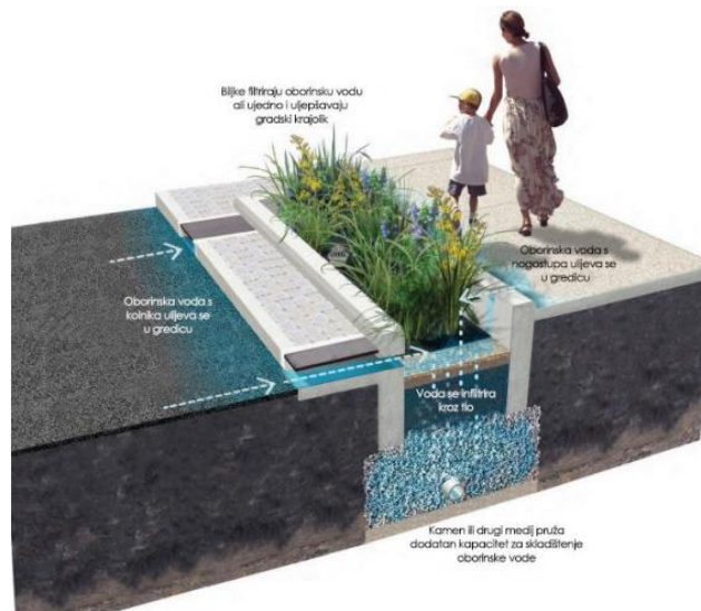
Slika 3.3.5. Presjek kišnog vrta.
