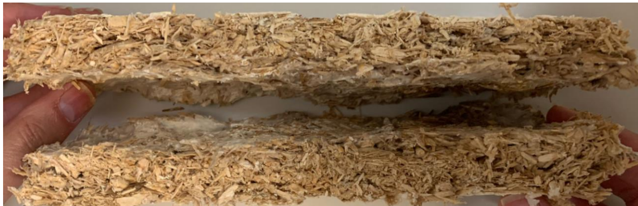
Slika 25. Prikaz poprečnog presjeka kompozita pripremljenog za testiranje savojne čvrstoće
