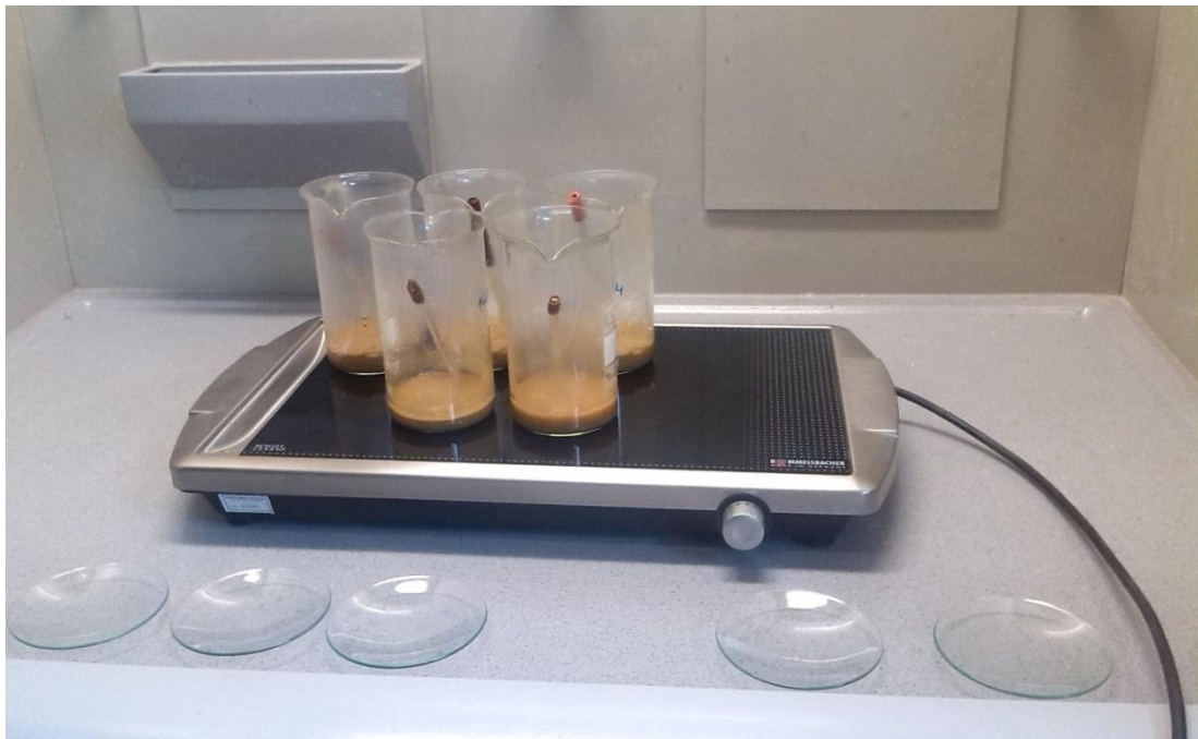
Slika 6: Zagrijavanje uzoraka radi razgradnje organske tvari
