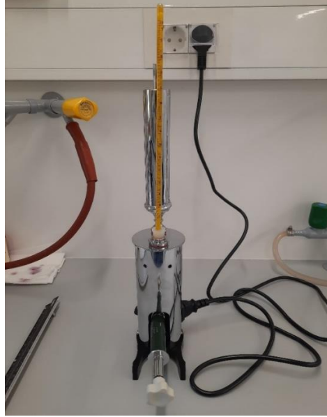
Slika 5. Salleronov ebulioskop Izvor: Brleković V.
