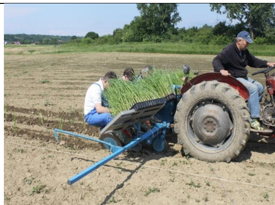
Slika 8.3.4.4. Sadjnja sadilicom za presadnice (autor: N. Bilandžija)
