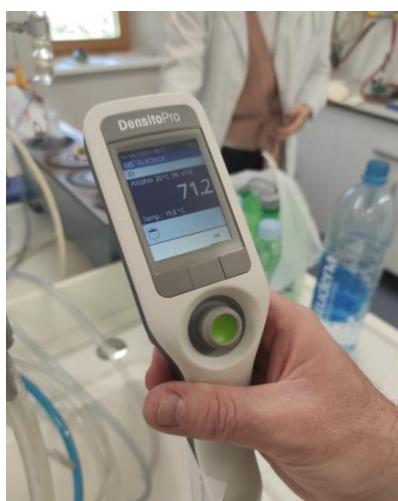
**Slika 1. Digitalni denzitometar**
