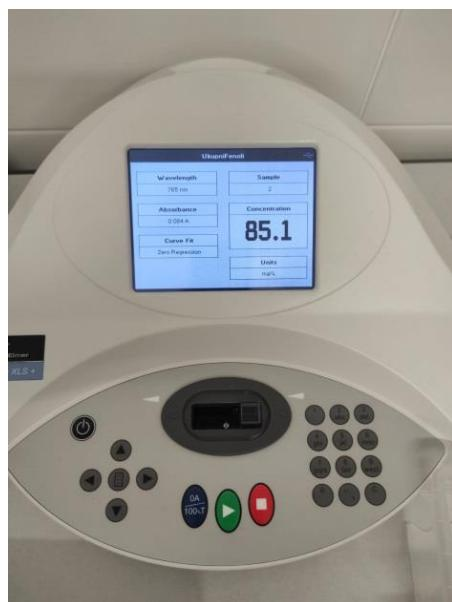
Slika 5. Spektrofotometar Perkin Elmer, Lambda XLS +
