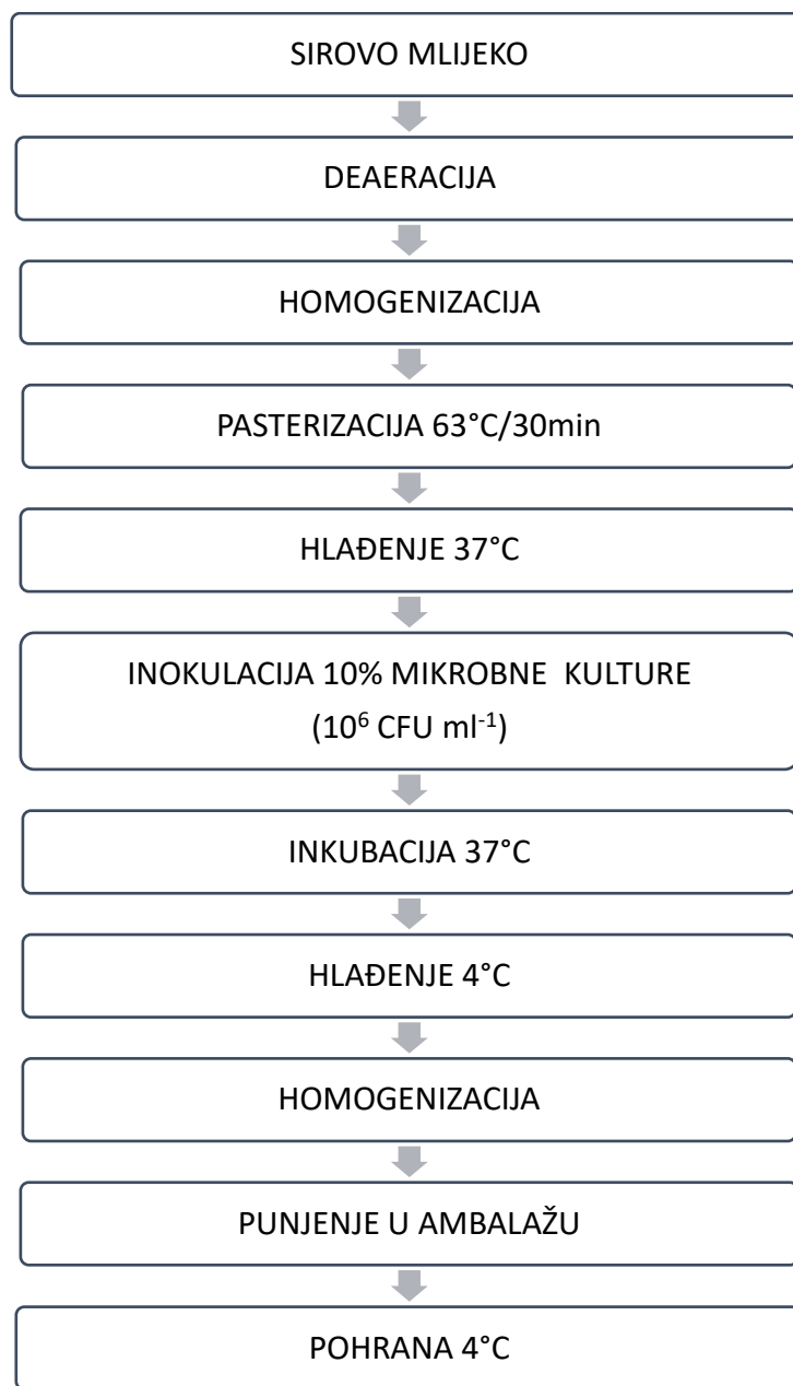
Slika 3.4. Prijedlog tehnologije za proizvodnju fermentiranog mlijeka magarice s dodatkom probiotičkih bakterija
