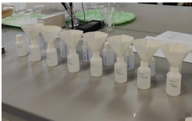
Slika 3.4.1. Filtracija uzoraka vode uzetih iz rijeke Kupe.
