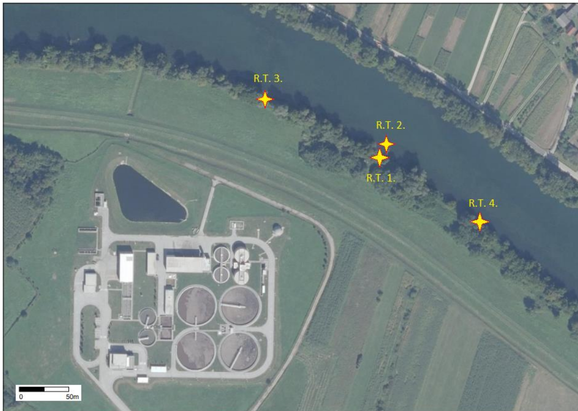
Slika 3.3.1. Lokacije uzorkovanja vode iz Rijeke Kupe gdje: R.T.1. (radna točka 1) prikazuje prikupljanje uzoraka na ispustu uređaja za pročišćavanje otpadnih voda, R.T.2. – 1 m nizvodno od ispusta, R.T.3. – 100 m uzvodno, a R.T.4. – 100 m nizvodno od ispusta uređaja za pročišćavanje otpadnih voda.
