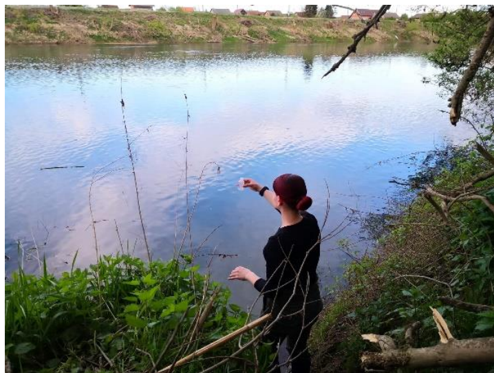
Slika 3.3.2. Uzimanje uzoraka vode iz rijeke Kupe 100 m uzvodno od ispusta uređaja za pročišćavanje otpadnih voda.
