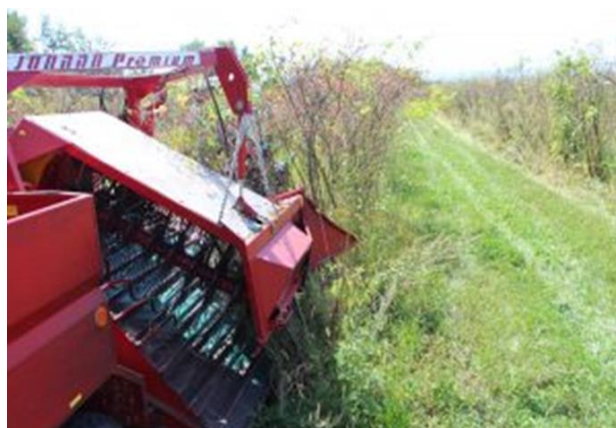
Slika 2.8. Strojno branje pasje ruže
