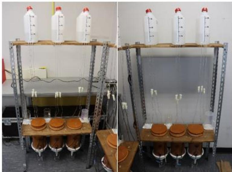
Slika 3.3.3.1. Sustavom umjerenog navodnjavanja kolona s tlom
