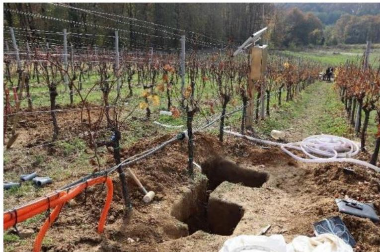
Slika 3.2.1. Iskop jame za postavljanje tlačnih lizimetara
