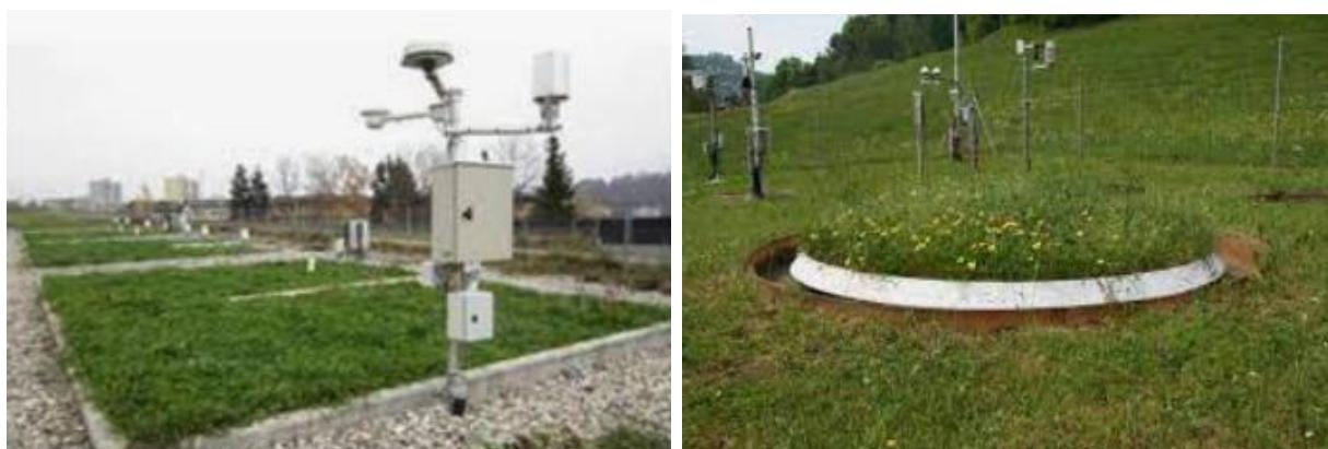
Slika 2.5.1. Pravokutni lizimetar (lijevo) i kružni lizimetar (desno)
