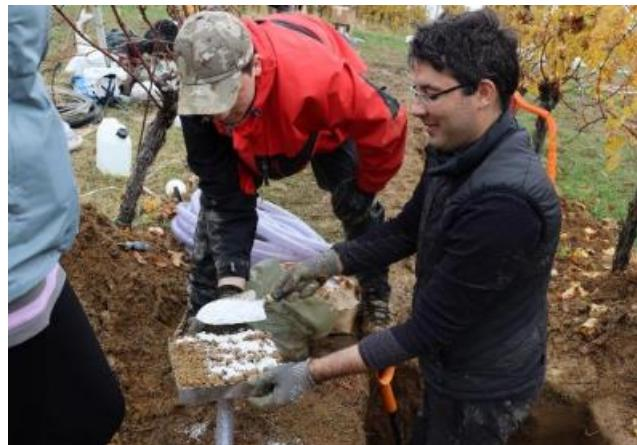
Slika 3.2.3. Zasipavanje lizimetra kvarcnim brašnom
