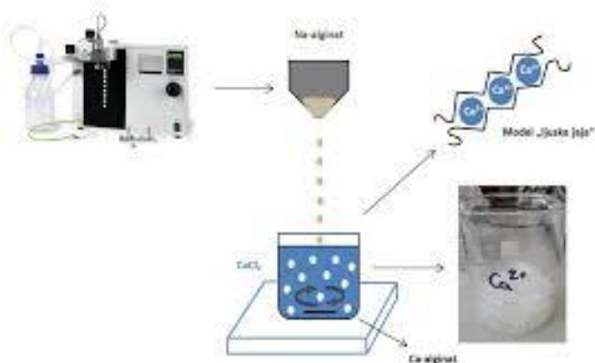
Slika 3.1.1. Shematski prikaz priprave mikrosfera kalcijevog karbonata (Bedek, 2018)
