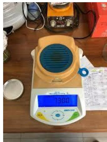
Slika 3.4.1. Halogeni vlagomjer za mjerjenje udjela suhe tvari (Haramija, 2019)
