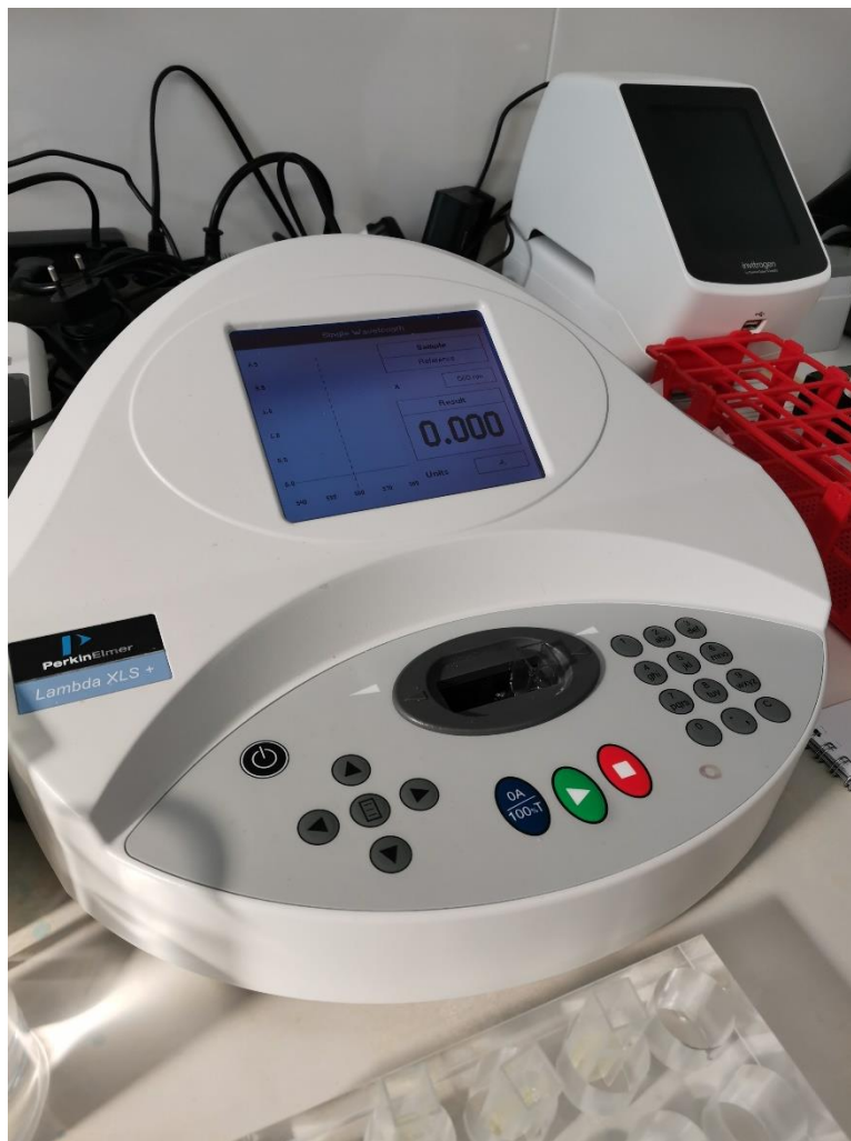
Slika 3.5.1. Mjerenje vrijednosti uzorka spektrofotometrom (Izvor: Dario Srebačić)
