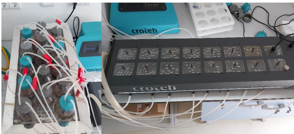
Slika 3.2.7.1. Bioreaktor za anaerobnu digestiju (vlastita arhiva)
