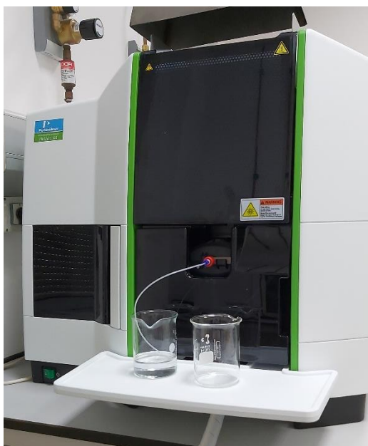
Slika 3.2.5.2. Atomski apsorpcijski spektrometar (vlastita arhiva)
