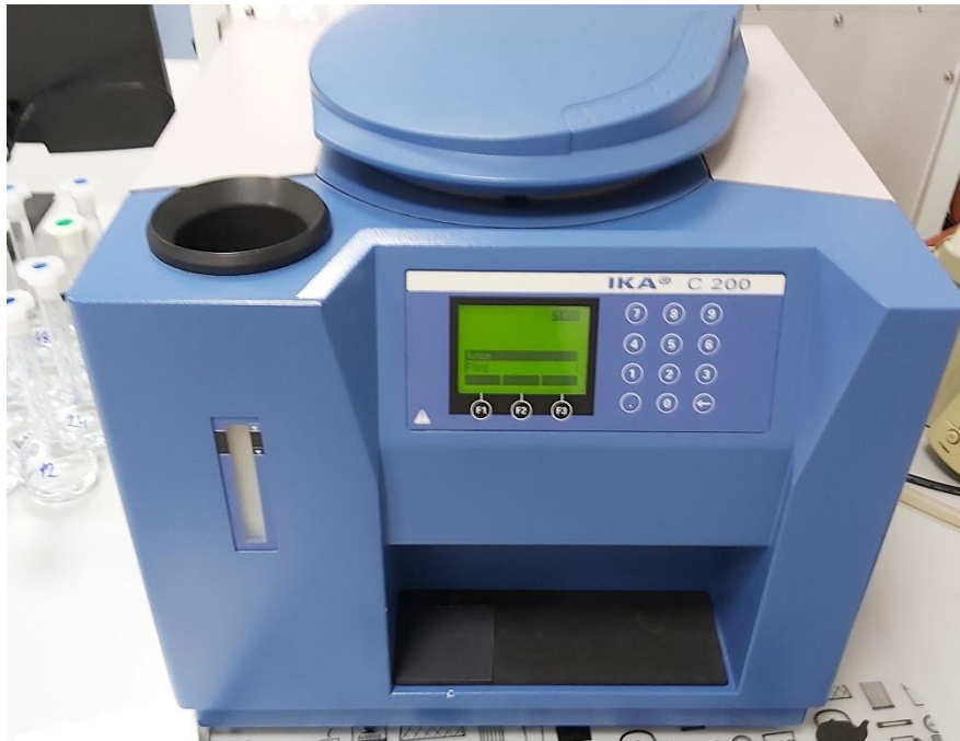
Slika 3.2.6.1. Adijabatski kalorimetar (vlastita arhiva)
