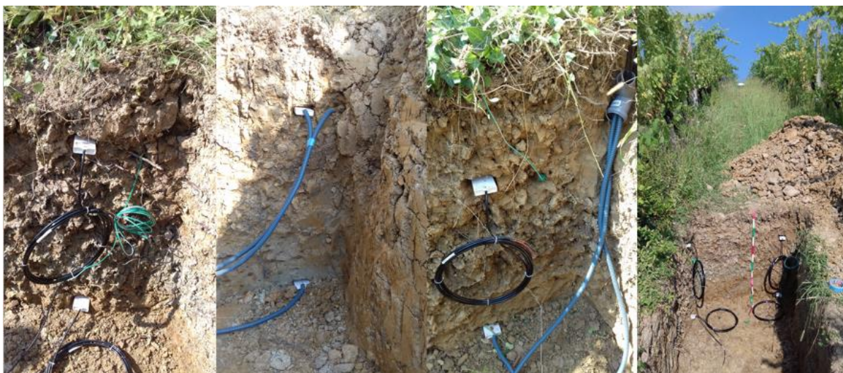
Slika 3.7. Postavljanje i položaj TDR senzora i tenziometara na P3 poziciji
