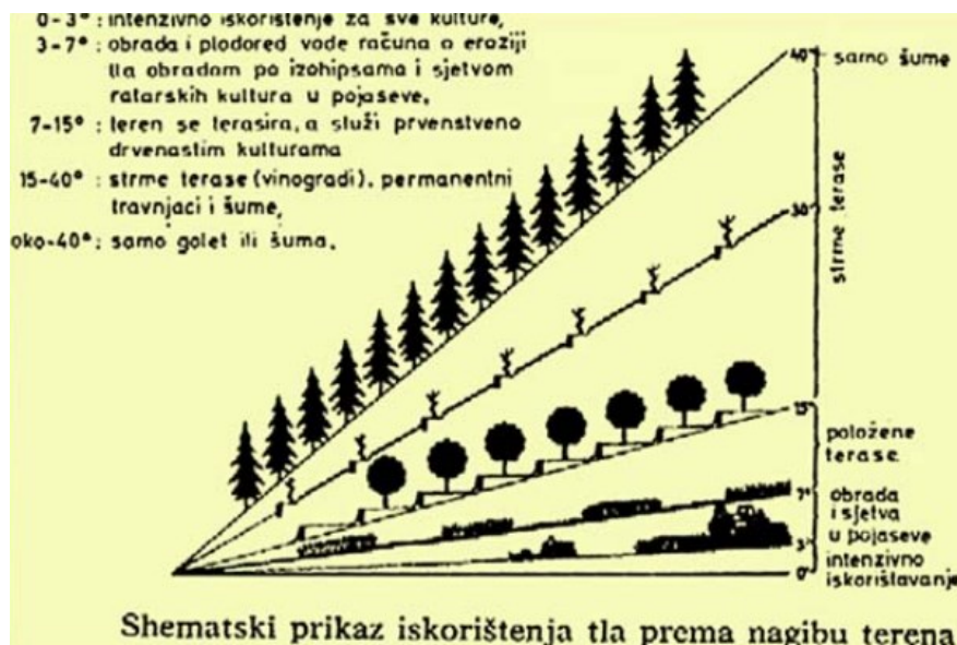
Slika 2.1.1 Shematski prikaz iskorištavanja tla prema stupnju nagiba
