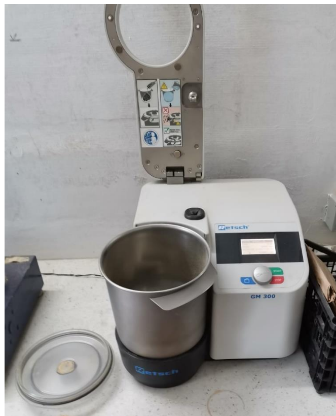
Slika 3.2.7. Laboratorijski mlin Retsch GM 300 Izvor: Vlastita fotografija
