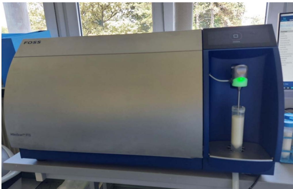
Slika 1. Milkoscan FT3 (Izvor: Foss Electric, Danska)
