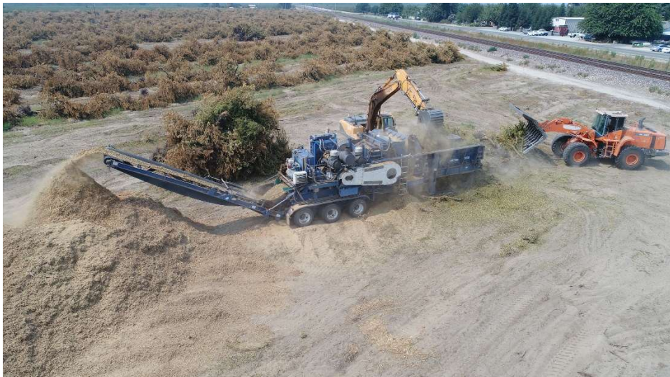
Slika 4. Usitnjavanje uklonjene biomase na mjestu uklanjanja
