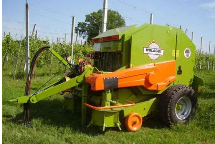
Slika 6. Preša za prikupljanje i prešanje orezanih ostataka u okrugle bale (Spinelli i sur., 2009.)
