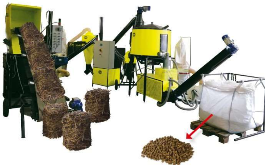
Slika 12. Sustav za peletiranje orezane biomase EPS
