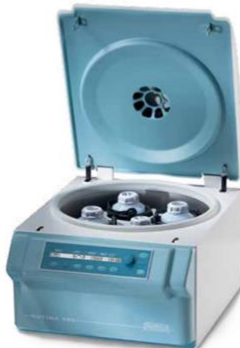
Slika 3.6. Uređaj za centrifugiranje uzoraka mesa
