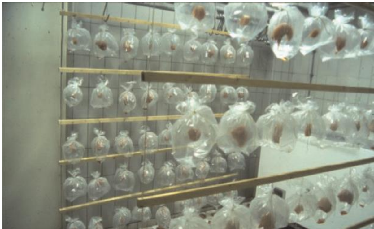
Slika 3.2. Prikaz uzoraka prilikom mjerenja SZV mesa metodom vrećice
