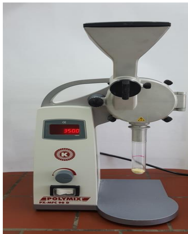
Slika 2.3.2.1. Stenvert mlin (Kljak 2020.)
