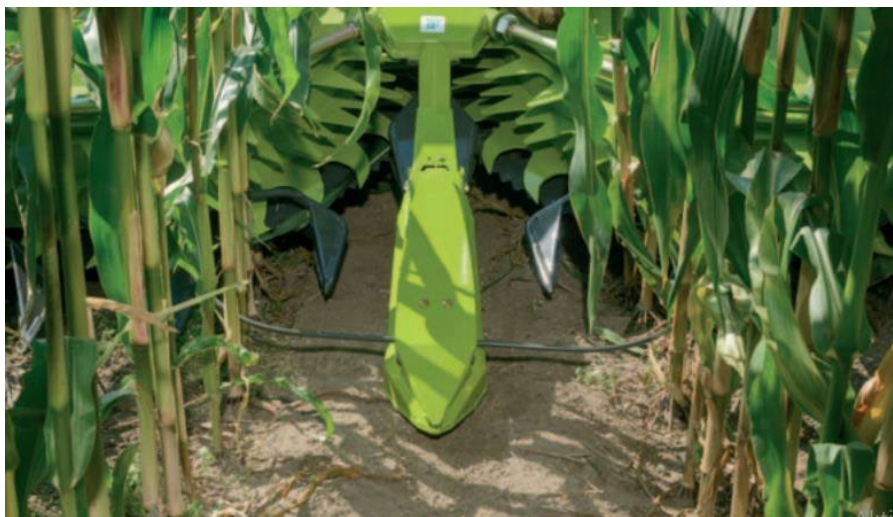
Slika 7.1. Mehanički osjetnici (tiala) na kombajnu
