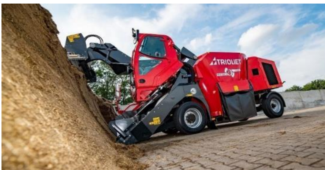
Slika 4.9. Samokretni stroj za izuzimanje, miješanje i raspodjelu silaže Trioliet Triotrac (Izvor: https://www.trioliet.com )
