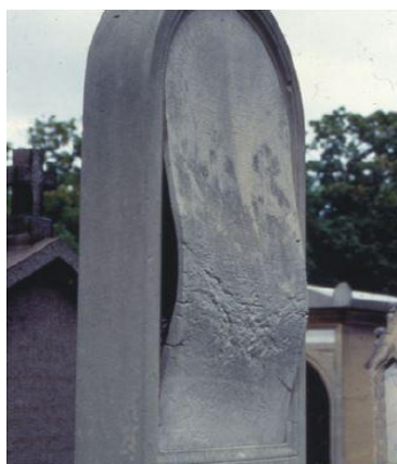
Slika 2.2.2. Deformacija arhitektonskog kamena izvor: Shushakova i sur., 2011.
