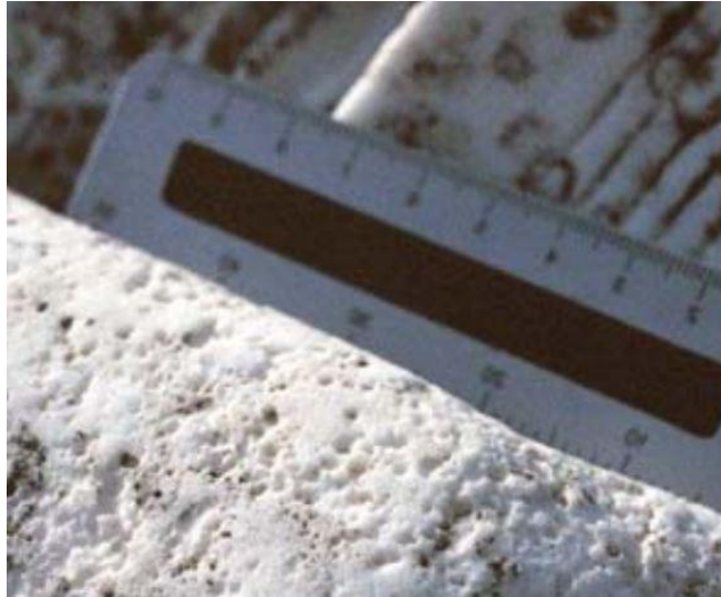
Slika 2.2.16. Oblik nastao gubitkom materijala - rupičanje izvor: Vergès-Belmin, 2008.
