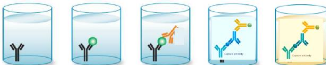
Slika 2.4.2.2. Shematski prikaz DASI ELISA testa
