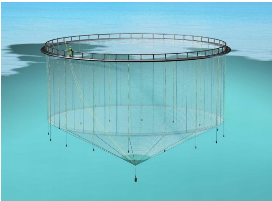
Slika 30. Shematski prikaz uzgojnog kaveza za tune Izvor: Grubišić L.
