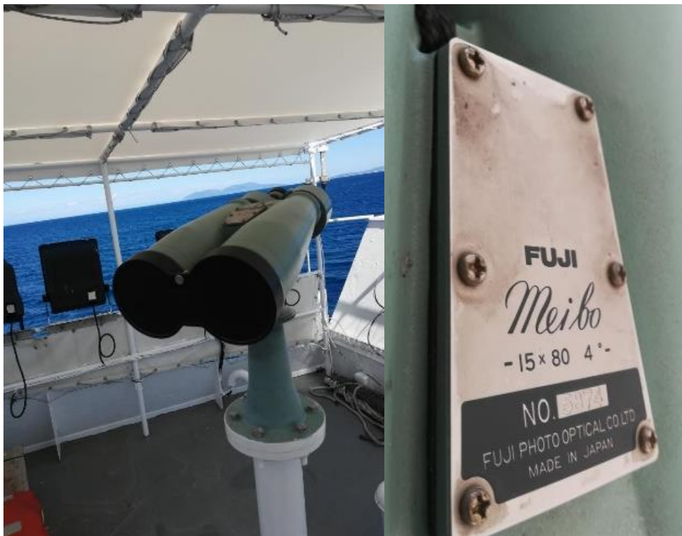
Slika 20. Prikaz dalekozora sa jačim uvećanjem tunolovca PELAGOS III
