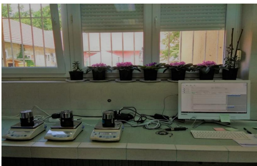
Slika 3.2.2.1.4. Neporušeni uzorci tla u cilindrima tijekom mjerenja na HYPROP sustavu.
