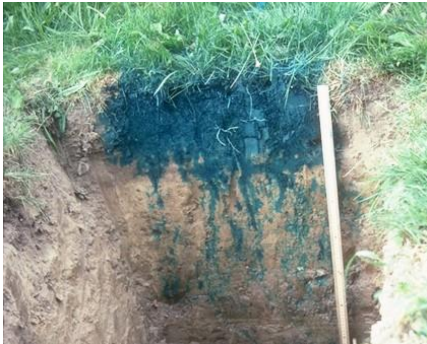
Slika 2.1.3.1. Prikaz preferencijalnog toka u makroporama tla označen plavom bojom
