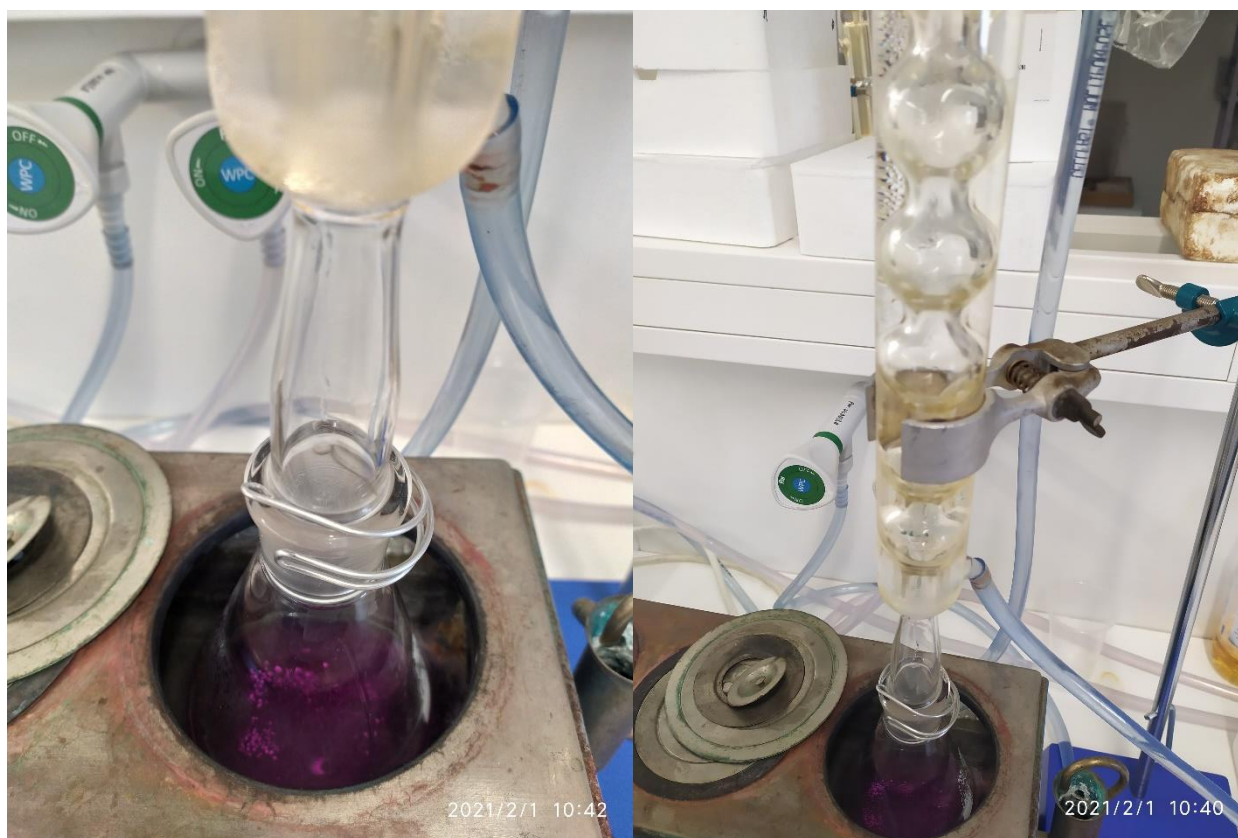
Slika 5.16. Metoda određivanja estera
