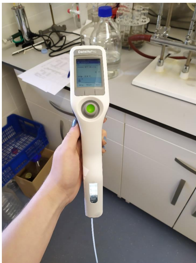
Slika 5.12. Uređaj za mjerenje alkoholne jakosti DensitoPro Izvor: autor
