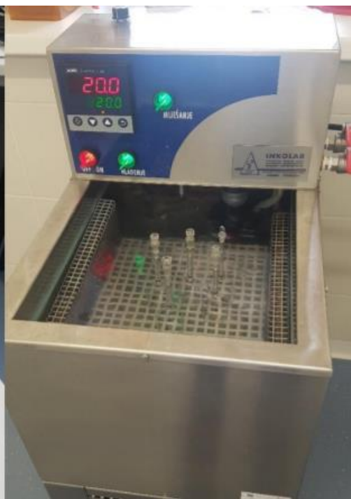
Slika 5.14. Temperiranje u vodenoj kupelji Izvor: Tina Lovin Mrak, 2020.
