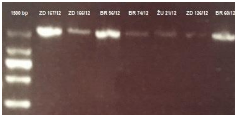
Slika 21. Prikaz elektroforeze PCR produkata veličine 1630 bp ( Monilinia spp.) u 1,5 % agaroznom gelu umnoženih parovima početnica Mon-TubF1/Mon-TubR1 u PCR reakciji (Hu i sur., 2011). Jažica 1: DNK ljestvica 1500 bp; jažice 2-8: Monilinia spp.
