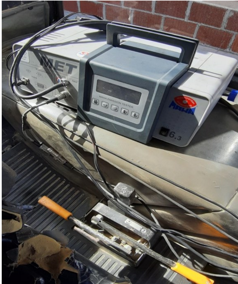
Slika 4.7. Uređaj za mjerenje sastava ispušnih plinova MAHA MET 6.3 u traktoru.
