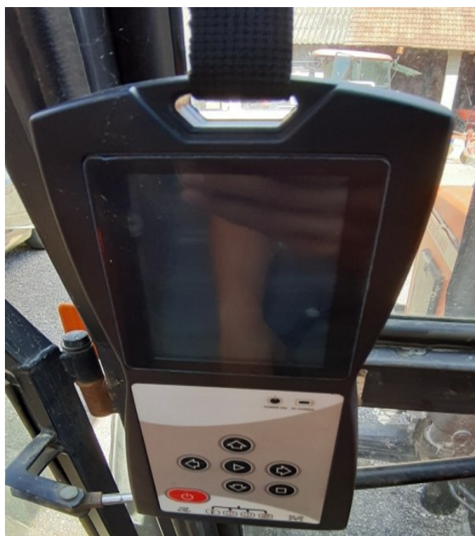
Slika 4.6. Monitor uređaja za prikaz temperature i broja okretaja motora MAHA MET 6.3. u traktoru.
