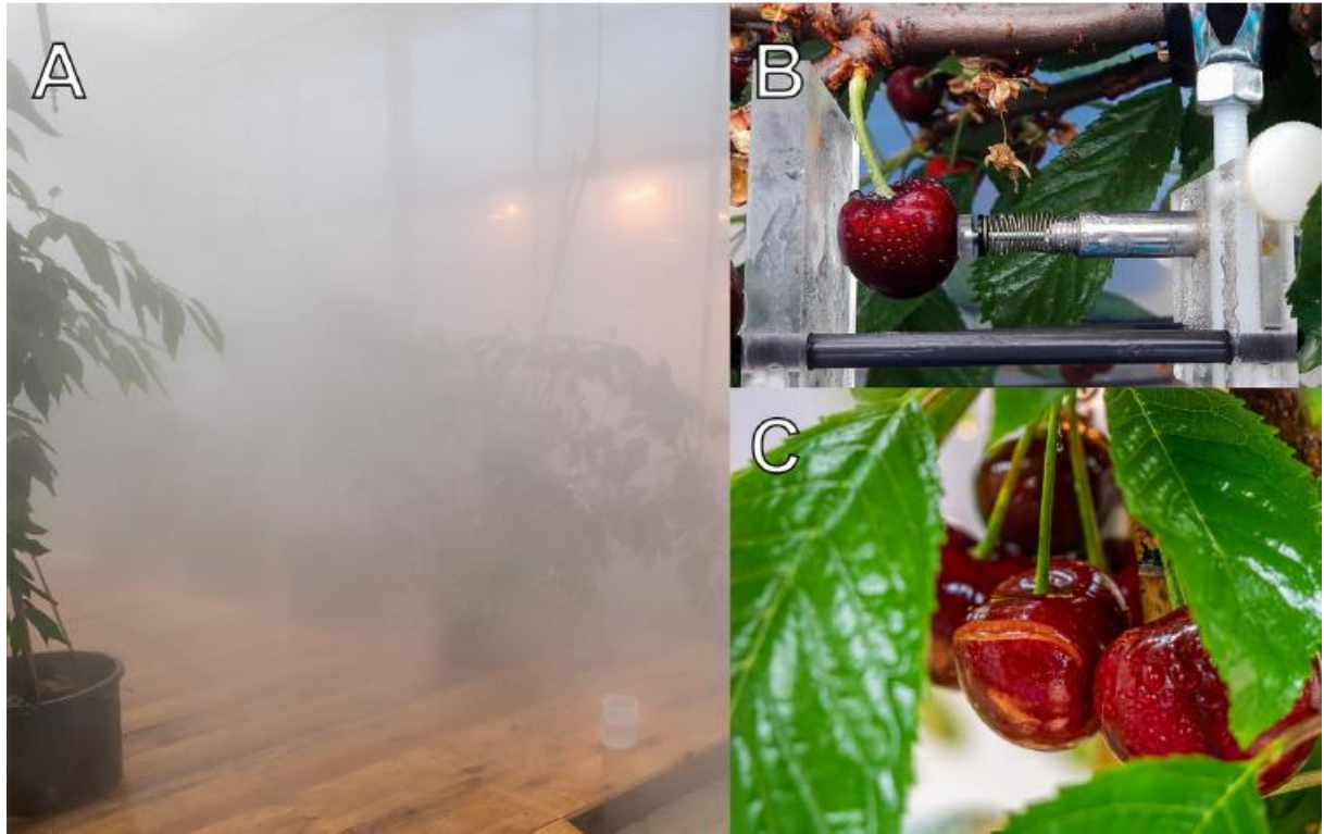
Slika 2.3. Trešnja pod simuliranom kišom u komori za maglu. A) Komora za maglu B) Plod trešnje montiran na linearni pretvarač za bilježenje promjene promjera C) Raspuknuti plodovi pod simuliranom kišom (Izvor: Winkler i sur. 2020)
