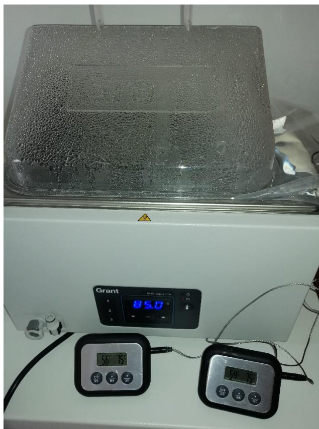
Slika 4.6. Prikaz vodene kupelji sa ubodnim termometrima
