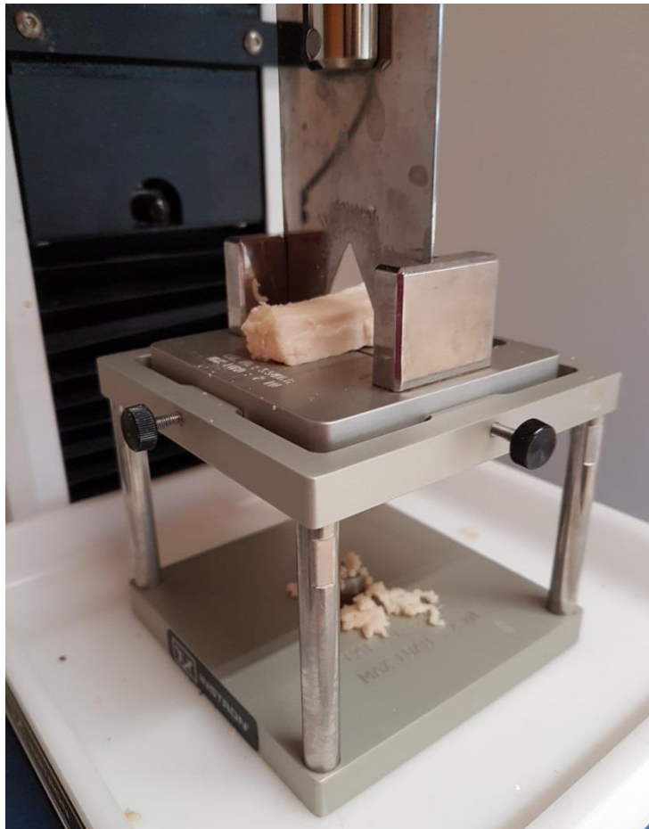
Slika 4.9. Mjerenje mekoće mesa sa Warner-Bratzler rezivim sječivom
