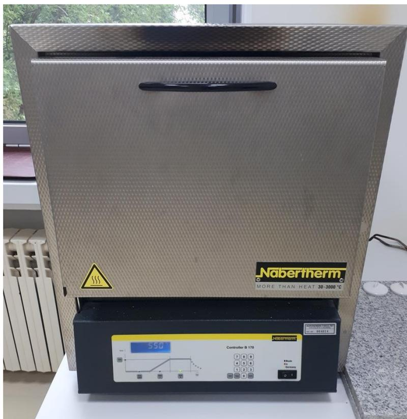
*Slika 7: Nabertherm B 170 mufolna peč
