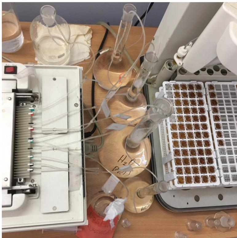
Slika 4.5.9. Protočni sustav automatskog analizatora SEAL Analytical AA3
