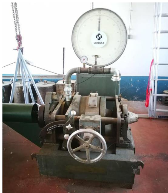
Slika 8. Hidraulička-pojasna kočnica Schenck tip U1-40
