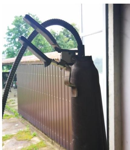
Slika 11. Sonda za ispitivanje ispušnih plinova
