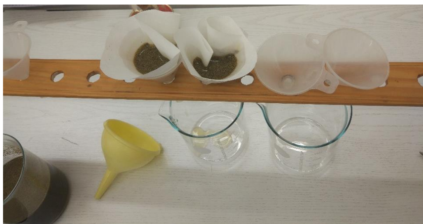
Slika 3.1.1. Filtriranje smjese pokrovnih biljaka
