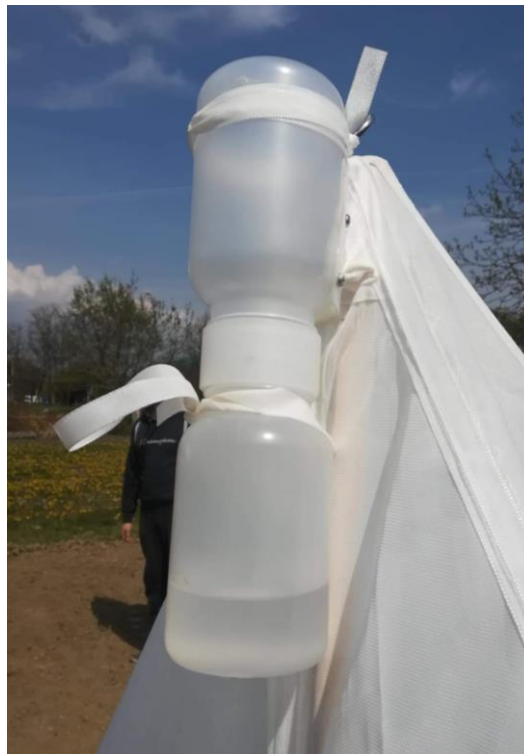
Slika 4.3. Plastična boca na vrhu klopke za sakupljanje entomofaune Snimila: Žganec K., 2019.
