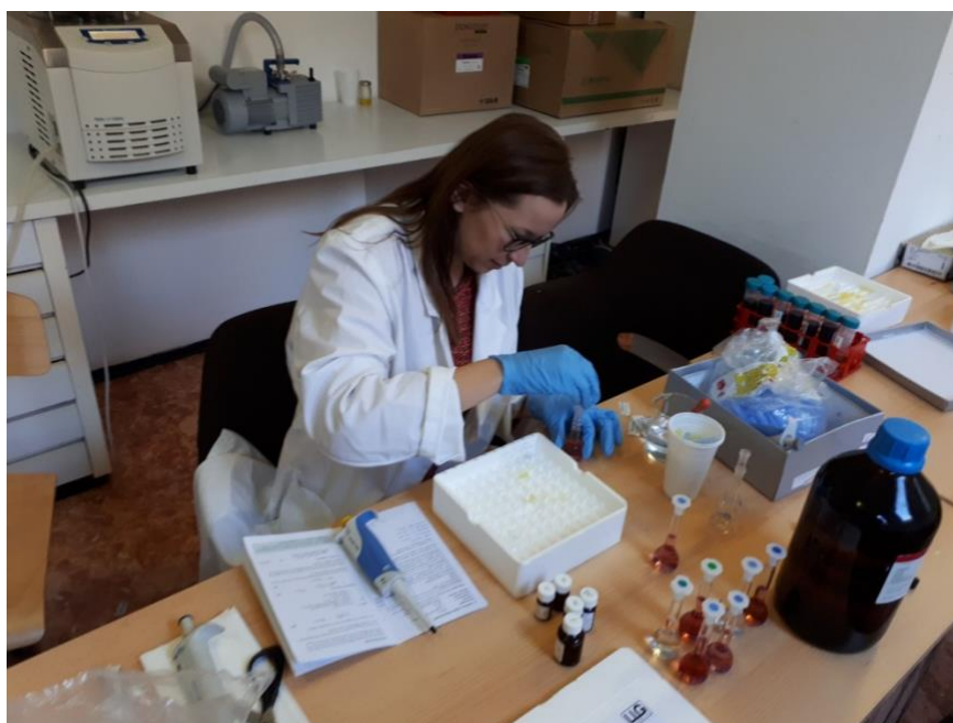
Slika 2. Razrjeđivanje uzoraka vina destiliranom vodom
