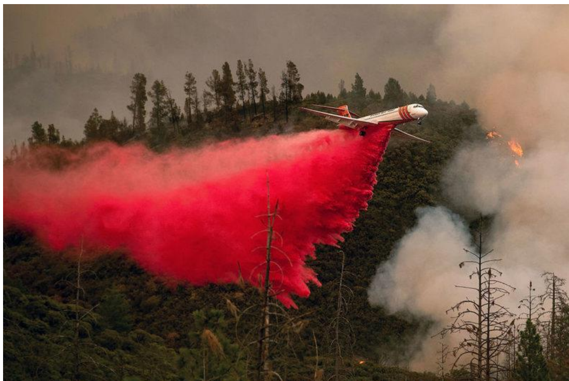
Slika 17. Vatrogasna protupožarna letjelica (primjena retardanata)
