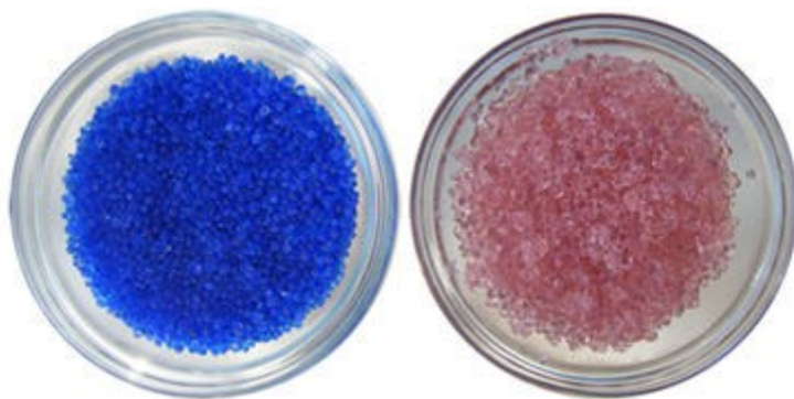
Slika 6. Silika gel prije i nakon upijanja vlage iz cvijeća Izvor: http://www.agrofleet.com.my/bluegel.html
