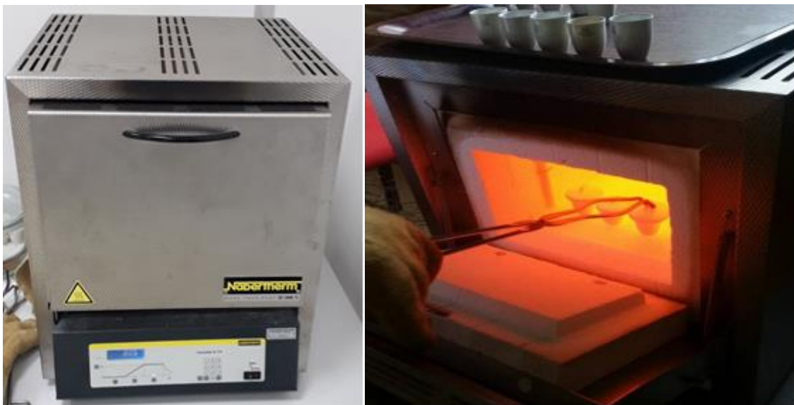
Slika 5. i 6. Mufolna peć za određivanje sadržaja pepela i koksa
