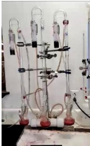
**Slika 13:** Aparatura za određivanje SO<sub>2</sub> u vinu metodom po Paulu
