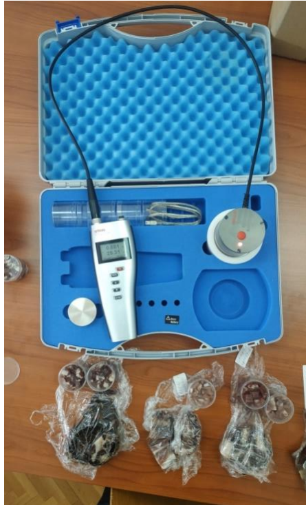
Slika 3.5. Mjerenje aktiviteta vode a_w Izvor: vlastito istraživanje
