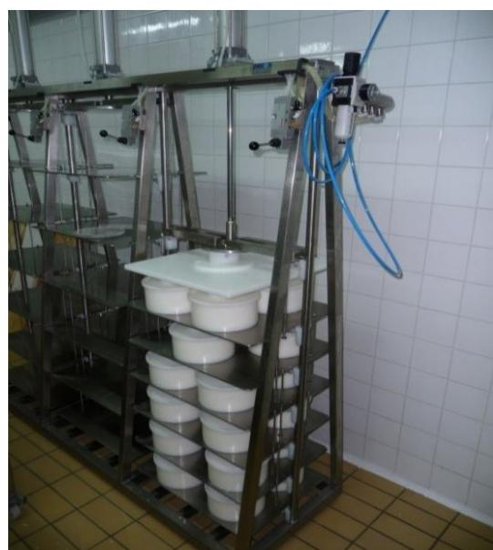
Slika 6. Prešanje sira pneumatskom prešom
