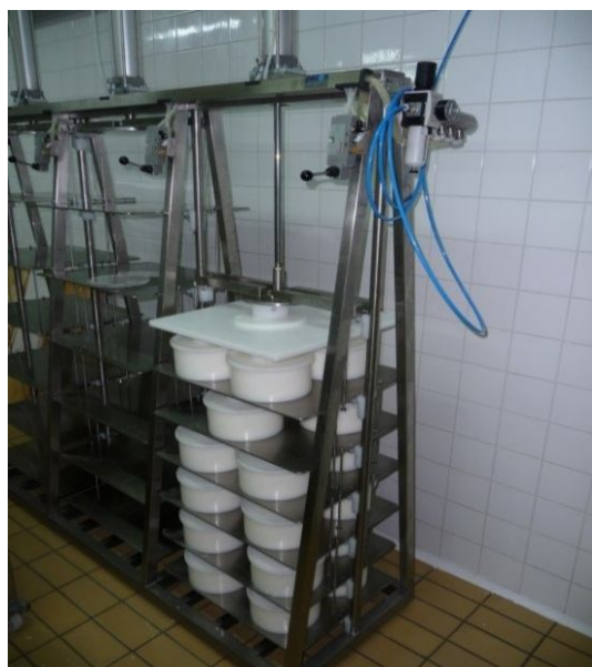
Slika 6. Prešanje sira pneumatskom prešom
