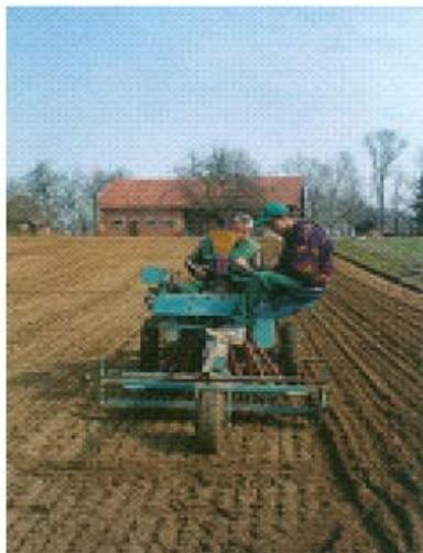
Slika 31. Sjetva lana na pokušalištu samohodnom sijačicom s razmakom među redovima od 10 cm
