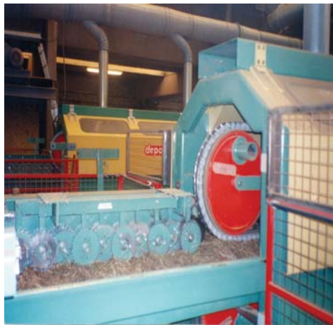
Slika 41. Turbina za razdjeljivanje stabljika lana
