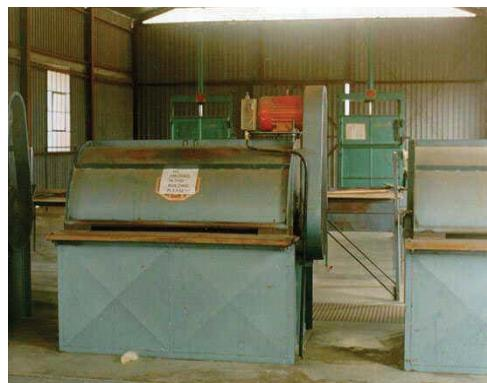
Slika 86 Strojevi za skidanje površinskog sloja listova sisala
