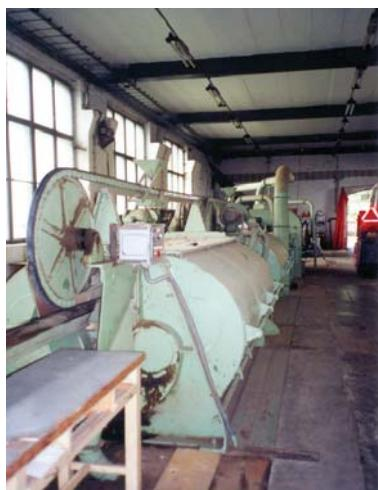
Slika 39. Turbina za preradu lana u vlakno
