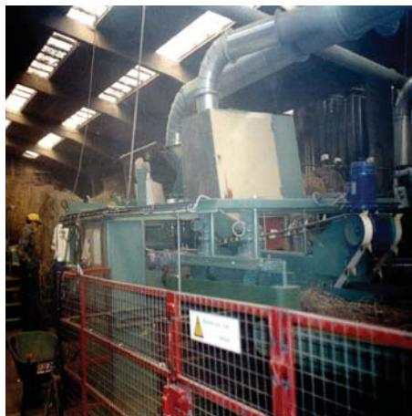
Slika 40. Turbina za odvajanje sjemena od stabljike
