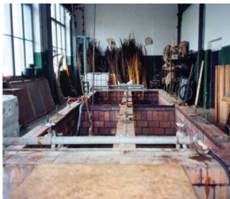
Slika 38. Močenje lana u bazenu s toplom vodom
