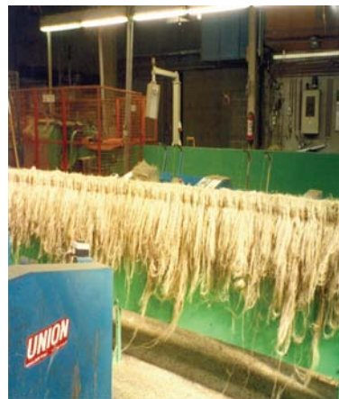
Slika 45. Dugo vlakno na izlasku iz turbine
