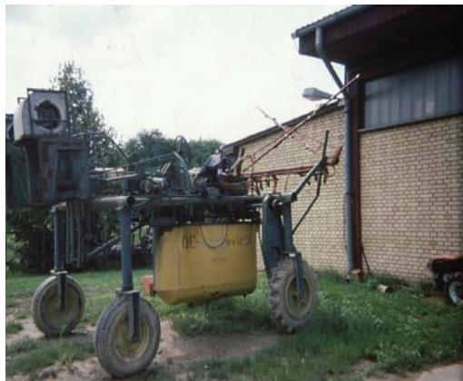
Slika 105. Stroj za zаламање duhana
