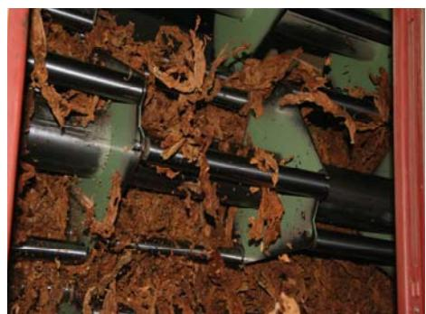
Slika 126. List duhana u cilindru za navlaživanje
