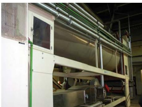
Slika 125. Cilindar za navlaživanje duhana
