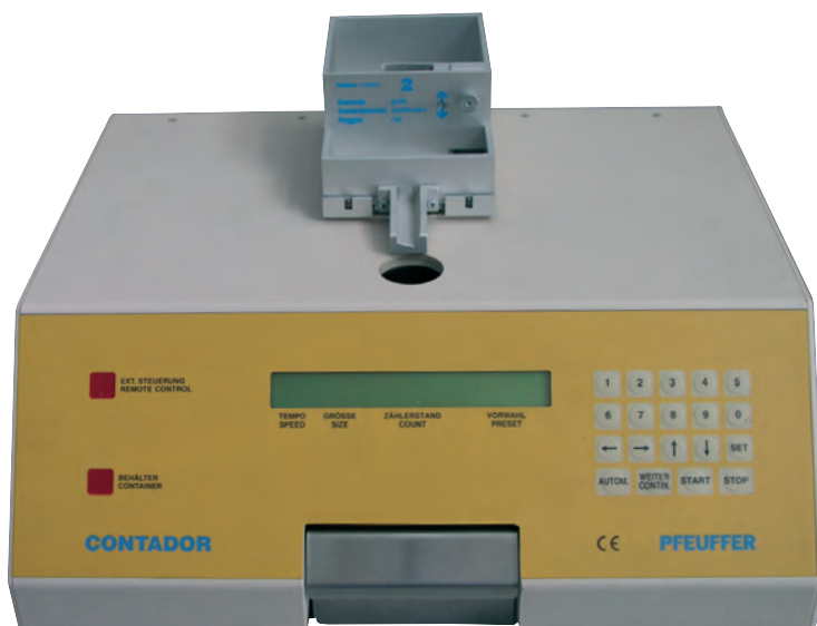
Slika 1. Brojač sjemenka s fotočelijom (snimila A. Pospišil)
