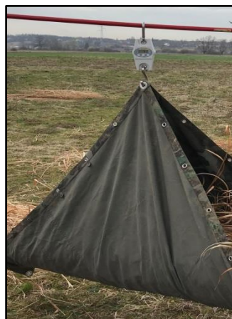
Slika 23. Vaganje požete biomase (Izvor: Božidar Matin - vlastita arhiva)
